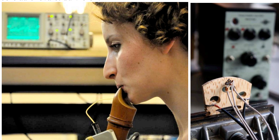
A gauche, une flûtiste se prête à l'expérience de mesure de la pression buccale en jeu musical. A droite, un chevalet de violon est équipé d'accéléromètres et d'actuateurs piézo-électriques à des fins de contrôle actif.
