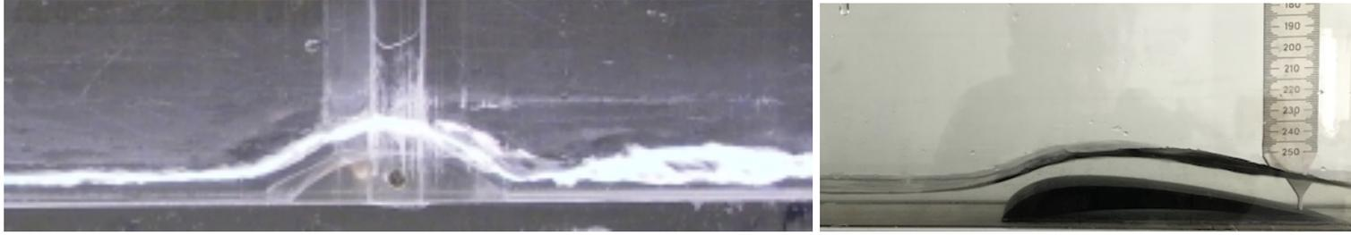
FIGURE 51 – Ecoulement supercritique  $F > 1$ , la surface libre est déviée vers le haut et le fluide est ralenti. Cuve de l'ENSTA Palaiseau à gauche, cuve Sorbonne-U à droite, photos PYL
