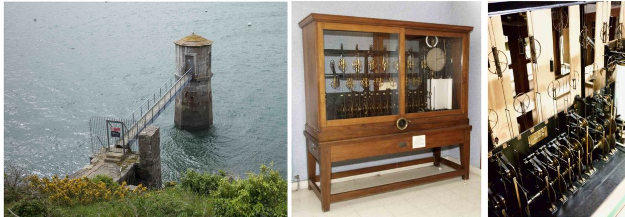
FIGURE 35 – Gauche Marégraphe de Saint Malo (côté Tour Solidor), Photo PYL Centre : Le prédicteur de marée du S.H.O.M. à Brest, construit par Kelvin-Bottomley en 1924 sous le nom de TP n°6. <https://hal.science/hal-04317855/document>. Droite Tide Predictor n°3 du SHOM (1900) dans les réserves du musée des Arts & Métiers, Photo PYL
