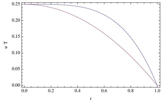
FIGURE 2 – Température en bleu (courbe supérieure) et vitesse en rouge (courbe inférieure) dans un tube à nombre d'Eckert  $E = 1/Pr$ .
