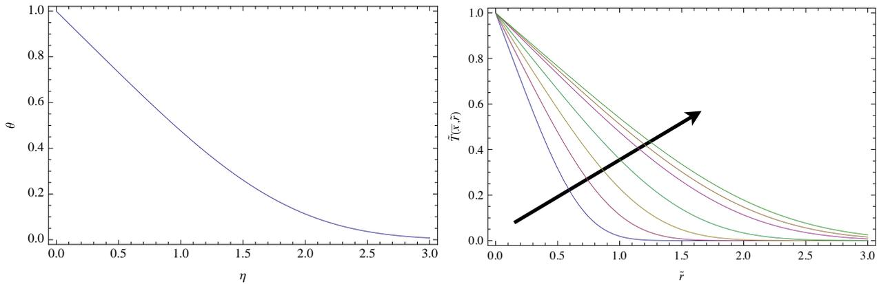
FIGURE 3 – La fonction autosemblable solution du problème à gauche. A droite des profils de températures déduits de la précédente, flèche dans le sens des  $\bar{x}$  croissants, .050 .125 .25 .5 .75 1 1.25 et 1.5
