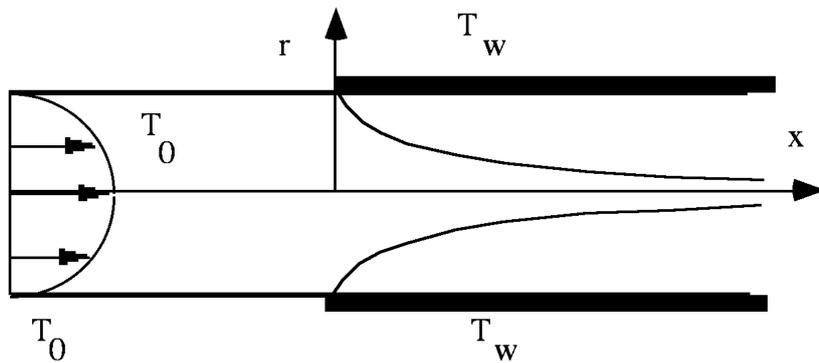
FIGURE 1 – le tube maintenu à la température  $T_0$  en  $x < 0$  et à la température  $T_w$  en  $x > 0$
