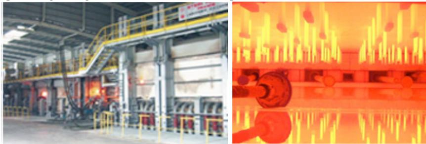
**Figure 3 :** images issues <http://www.stein-heurtey.com/glass-industry/float-glass-plant-tin-baths.html>, à gauche le four vu de l'extérieur et à droite une image prise dans le four, on voit un galet qui entraîne l'écoulement.
