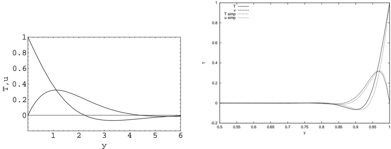
A gauche, tracé de la vitesse et de la température ( $Pr = 1$ ) approchées dans la couche limite pariétale. A droite, tracé de la vitesse et de la température calculés par simulation numérique directe ( $Gr = 10^6$ ) des équations et superposition de l'approximation proposée.
