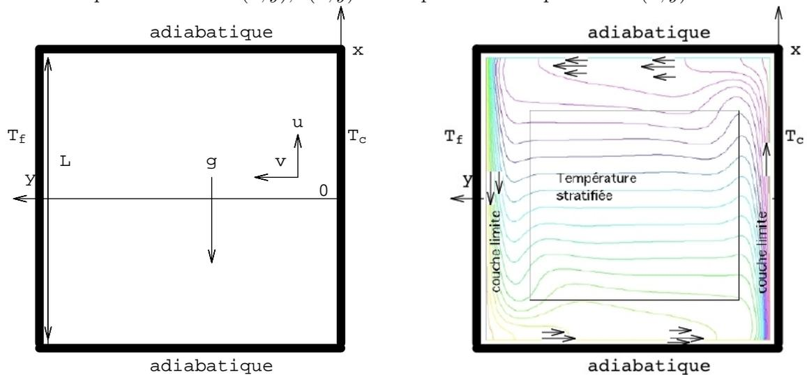
Gauche : notations, l'axe  $x$  est vertical dirigé vers le haut. La paroi verticale de droite que l'on étudie plus particulièrement ( $-L/2 < x < L/2$ ) est à la température  $T_c$  uniforme. La paroi de gauche est refroidie à la température  $T_f$  uniforme.
