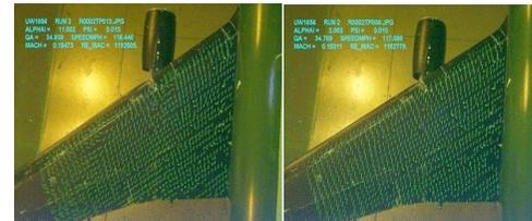
Compilation d'images prises lors d'un essai aux fils de laine sur une plage d'incidence de 0 à 26°. Les photos ont été prises dans la soufflerie de Kirsten en utilisant des minis fils de laine fluorescents. Le décollement commence à l'extérieur de l'aile et progresse vers l'intérieur.
