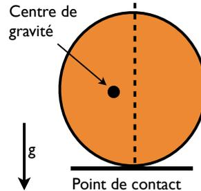
2) Un cercle de rayon R sur un support plan: si le centre de gravité est au centre du cercle, l'état stationnaire est neutre. Discuter de la stabilité si le centre de masse est au dessus du centre du cercle ou bien en dessous.
