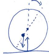
ici le centre de masse est en dessous du centre du disque et on suppose une petite perturbation d'angle  $\theta$  par rapport à l'état stat. Le moment des forces ramène le système vers son état stat. → STABLE
