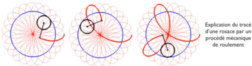
Explication du tracé d'une rosace par un procédé mécanique de roulement
