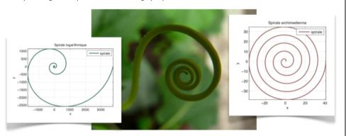
On peut définir des spirales avec  $x = r \cos(\theta)$  et  $y = r \sin(\theta)$ , mais ici le rayon r dépend de l'angle  $\theta$ . Pour la spirale logarithmique, on a la loi  $r = a^{\theta}$ , (a puissance  $\theta$ ) et pour la spirale Archimédienne, on a  $r = a\theta$ , ou a est un paramètre fixe, par exemple 1.3.
