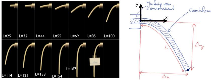
Les paramètres du système sont: la densité linéique de la poutre:  $\lambda = 0.45$  kilogrammes par mètre; la longueur de la poutre  $L$ ; l'accélération de la gravité  $g = 9.81$ ; la rigidité en flexion de la poutre  $B$ , en Newton-mètres carrés.
