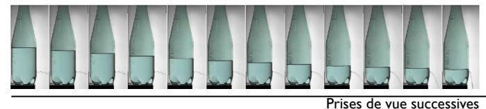
L'image toricelli.tif représente la vidange d'une bouteille de Badoit qui a été percée d'un petit trou de diamètre  $d$ . C'est l'expérience de Toricelli. Avec l'équation de Bernoulli, on montre que la vitesse du jet à un temps donné est égale à  $\sqrt{2gh}$ , avec  $h$  la hauteur entre le trou et la surface de l'eau, et  $g=9.81\text{m/s}^2$ . En prenant en compte la conservation du débit, on montre que la hauteur  $h$  évolue dans le temps comme ceci
