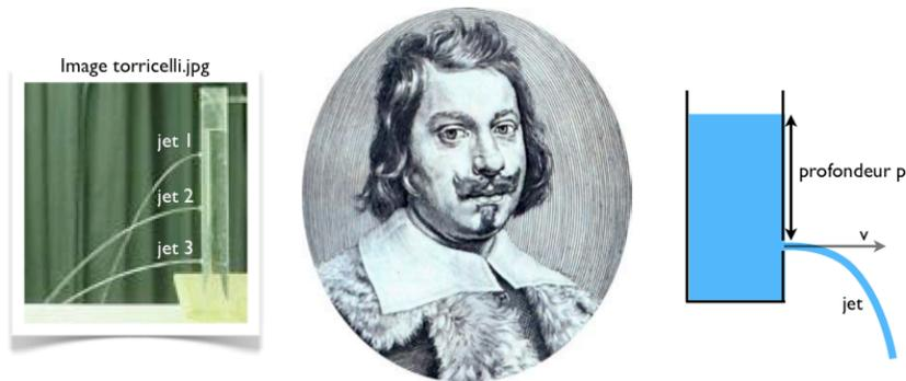
Dans ce TP, nous allons étudier la forme des jet, et montrer que ce sont bien des paraboles. Ensuite nous allons comparer les caractéristiques mesurées de ces paraboles avec les paraboles prédites par la théorie.
