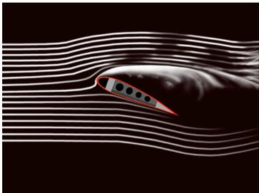
Point de stagnation sur le bord d'attaque d'un profil d'aile
