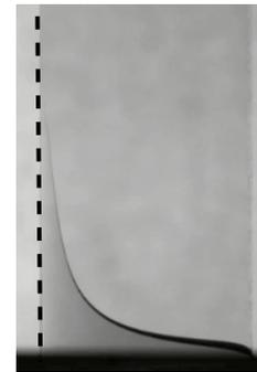
**Ex5:** Montée capillaire entre deux plaques: donner l'expression de la hauteur de l'interface entre deux plaques de verres (les deux plaques sont presque parallèles, elles font un petit angle alpha et sont en contact le long de la ligne pointillée).
