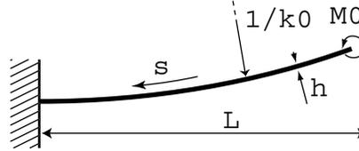
FIG. 1 – L'évolution dynamique d'un fragment qui suit la rupture initiale d'une tige fragile est modélisé par la libération au temps  $t = 0$  d'une tige de longueur  $L$  fixée, de courbure initiale  $\kappa_0$  ne possédant pas de vitesse initiale.
