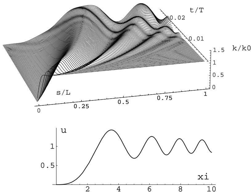
FIG. 2 – En haut : simulation numérique des équations de Kirchhoff dynamiques pour une configuration initiale en demi-cercle  $\kappa_0 = \pi/L$ . La courbure au bord libéré  $\kappa(0, t)$  relaxe vers zéro en quelques pas de temps puis est donnée dans le régime intermédiaire (2) par la solution auto-semblable (3). Aux temps ultérieurs, des réflexions se produisent sur le bord encasté  $s = L$ . En bas : solution auto-semblable décrivant le régime intermédiaire  $\xi = s/\sqrt{\gamma t}$ .
