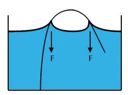
**1.** Une lamelle élastique peut être fortement courbée par des forces capillaires. L'équilibre dépend de la rigidité de la lamelle, de la tension de surface, et de la hauteur de bain. La non-linéarité du problème fait que de multiples configurations d'équilibre stables coexistent pour la même hauteur de bain.
