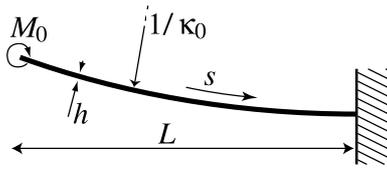
**Fig. 1.** L'évolution dynamique d'un fragment qui suit la rupture initiale d'une tige fragile est modélisée par la libération au temps  $t = 0$  d'une tige de longueur  $L$  fixée, de courbure initiale  $\kappa_0$  ne possédant pas de vitesse initiale.
