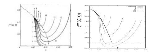
Le frottement parétal réduit (pente de la vitesse à la paroi)  $f''(\xi,0) = \frac{\partial u}{\partial y}(x,0)\sqrt{x}$  fonction de  $\xi = |J|\sqrt{x}$ : résolution par une marche en avant en x (Steinrück (1994)) (gauche) résolution numérique différente montrant la séparation de la couche limite, chaque courbe est associée à une longueur de domaine différente  $x_{out}$  (droite).
