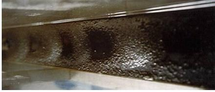
FIG. 3.2 – Ondes de sable observées par Coleman et Eling (d’après [8]). L’écoulement s’effectue de gauche à droite. Le canal mesure 10 cm de largeur.
