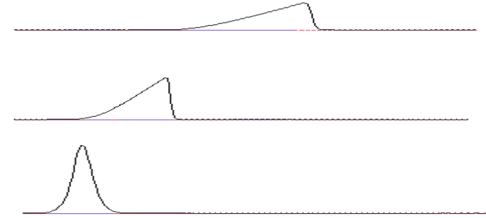
FIGURE 43 – De bas en haut les hauteurs de vague. Raidissement du profil formation d'un choc. Ce choc traduit le déferlement qui se produit sur une échelle courte et qui met en jeu des phénomènes physiques absents des équations de Saint-Venant. L'enroulement de la surface libre sur elle même est remplacée par une discontinuité. En pratique, cette discontinuité est lissée sur quelques points \Delta x par les schémas numériques, http://www.lmm.jussieu.fr/~lagree/SIEF/SIEF97/raid.mov
