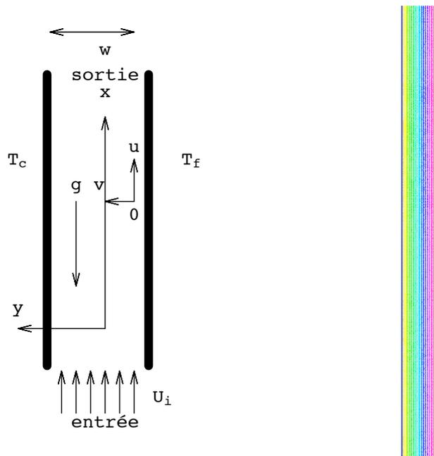
Gauche : notations, l'axe  $x$  est vertical dirigé vers le haut. La paroi verticale de droite est à la température  $T_f$  uniforme (intérieur froid de l'immeuble). La paroi de gauche est chauffée à la température  $T_c$  uniforme (température chaude extérieure). En bas en entrée on peut envoyer un courant de vitesse caractéristique  $U_i$
