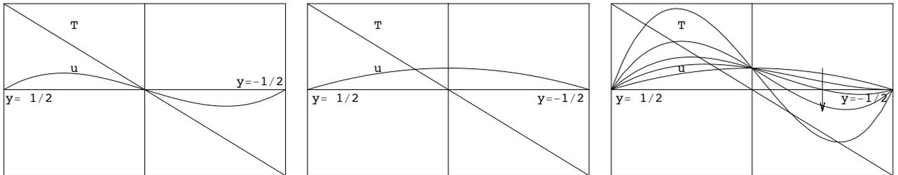
A gauche, tracé de la vitesse et de la température au travers du canal dans le cas sans pompe de convection libre uniquement. Au centre, cas avec pompe ; mais à dilatation négligeable, il n'y a que de la convection forcée. A droite, convection mixte, tracé de la vitesse et de la température pour différentes valeurs de  $K$  (flèche dans le sens des  $K$  croissants).
