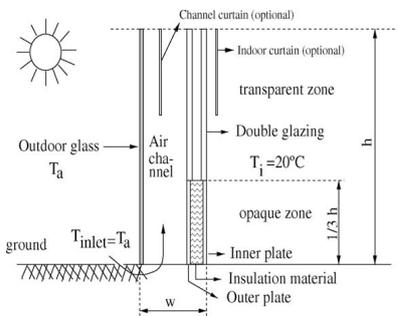
FIG. - la configuration réelle (issue de la bibliographie) que nous allons simplifier en un canal vertical avec deux parois à deux températures différentes. La configuration de l'énoncé est en dernière page.
