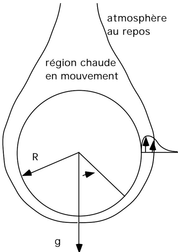
Soit  $R$  le rayon extérieur du pot,  $a$  l'épaisseur de la paroi ( $a \ll R$ ),  $g$  l'accélération de la pesanteur, on utilise les coordonnées cylindriques  $r, \theta, z$ , on choisit de mesurer  $z$  à partir de la verticale basse.  $z=0$  est donc la ligne inférieure du pot, le voisinage du bas du pot est la région où  $z$  est faible, c'est cette région que nous examinons au II et III. et nous établirons que localement on peut trouver une solution de similitude.
